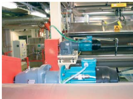
Linjdrifter. Observera endast två kablar till motorn.
