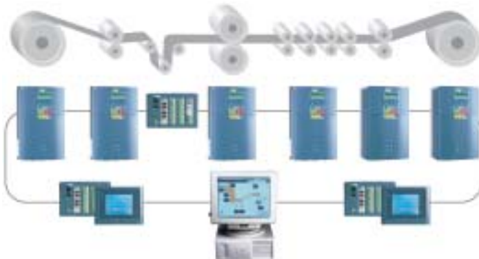
Schematisk bild över en konverteringslinje med drifter, operatörstationer och överordnad dator.
